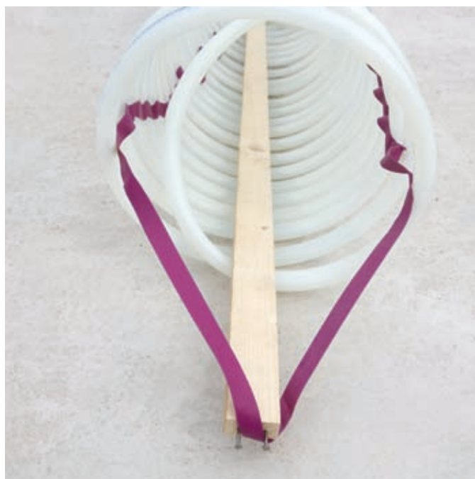
Rys. 76: Wykonanie węzła mocującego
