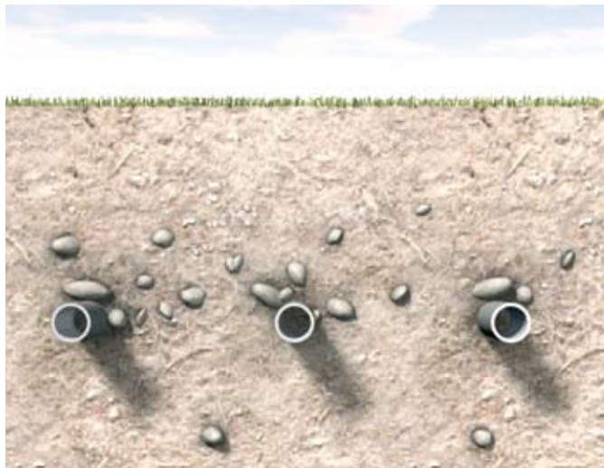
Wbudowanie kolektora RAUGEO PE-Xa
