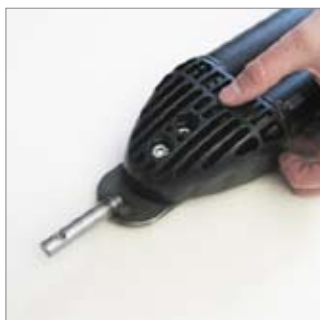
Rys. 02: Skręcić płaskownik z głowicą sondy.
