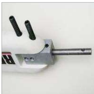
Rys. 02: Trzpień łączący włożyć w bloczek ze stali i przymocować kołkiem rozprężnym. Następnie wprowadzić bloczek w sondę i przymocować dwoma śrubami gwintowymi.
